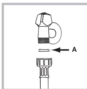
1. Вставьте прокладку A в конец водопроводного шланга и привинтите его к водопроводному крану холодной воды с резьбовым отверстием 3/4 газ (см. схему). Перед подсоединением откройте водопроводный кран до тех пор, пока из него не потечет чистая вода.
